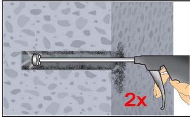
2f. Abschließend Bohrloch mindestens 2x mit Druckluft (min. 6 bar) (Anhang B 4) über die gesamte Verankerungstiefe (ggf. Verlängerung verwenden) ausblasen, bis die ausströmende Luft staubfrei ist.
