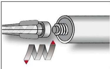
3. Statikmischer PIT-PSM, aufschrauben und Kartusche in geeignetes Auspressgerät einlegen. Bei Arbeitsunterbrechungen, länger als die maximale Verarbeitungszeit  $t_{work}$  (Anhang B 5) und bei neuen Kartuschen, neuen Statikmischer verwenden.
