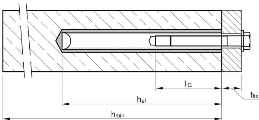
$t_{fix}$  = Dicke des Anbauteils
